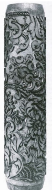
Abb. 3 Bemusterung von bereits grundierten Tapetenbahnen mit einer englischen Leimdruckmaschine für achtfarbige Hochdrucke, 1867, Exemplar der Pariser Fa. Gillou & Thorailleur (li.); Hochdruckwalze der Fa. F.A. James, Mitte 19. Jh. (re.) (aus: Lesley Hoskins, Kunst der Tapete. Geschichte, Formen, Techniken , Stuttgart 1994, S. 135).
