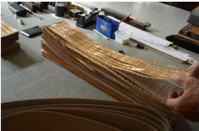
Abb. 23 Lösen der Bogenware von der Papplage, Firma Otto Mäckel – Spitzenpapier und Prägeanstalt Burgstädt (Foto: C. Nehr Korn-Stege).
