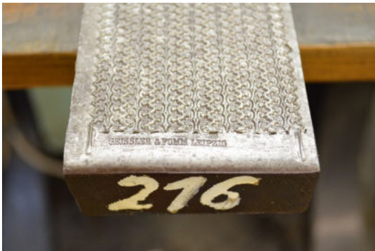
Abb. 19 Prägematrize – graviertes „Werkzeug“ in der Firma Otto Mäckel – Spitzenpapier und Prägeanstalt Burgstädt (Foto: C. Nehr Korn-Stege).
