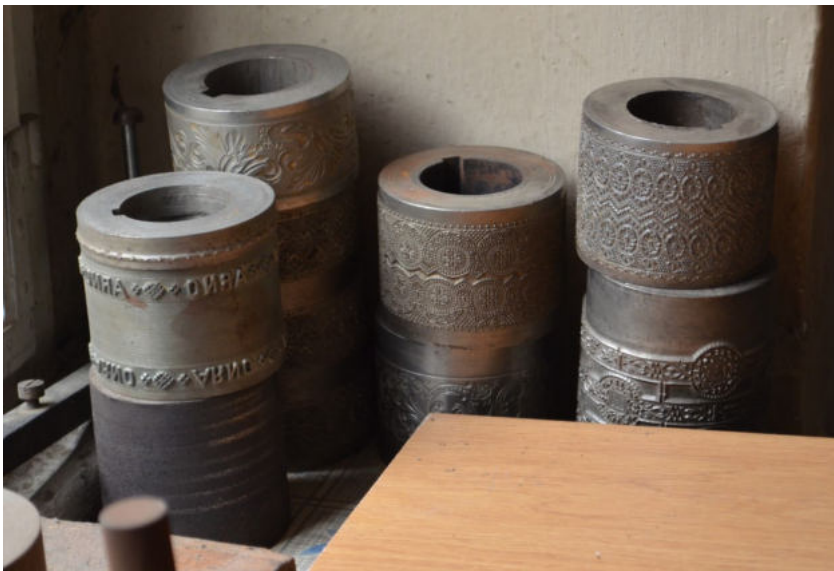
Abb. 17 Prägewalzen (Patrizen) in der Firma Otto Mäckel – Spitzenpapier und Prägeanstalt Burgstädt (Foto: C. Nehr Korn-Stege).
