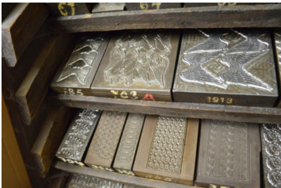
Abb. 20 Werkzeugfundus – Prägematrizen in der Firma Otto Mäckel – Spitzenpapier und Prägeanstalt Burgstädt (Foto: C. Nehr Korn-Stege).
