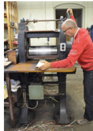
Abb. 22 Handhabung des Prägewalzwerkes in der Firma Otto Mäckel – Spitzenpapier und Prägeanstalt Burgstädt (Foto: C. Nehr Korn-Stege).
